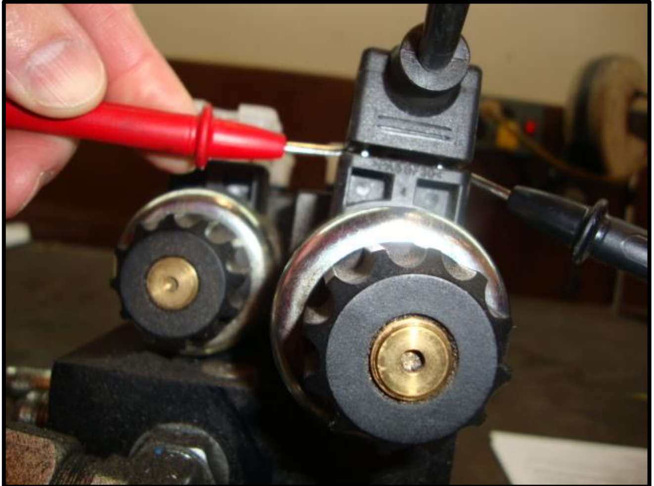
Fig. 8-4 Checking Din Plug Voltage
